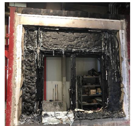
Il test termina quando l'integrità viene persa e le fiamme passano attraverso l'elemento. Il lato esposto al fuoco è carbonizzato e fuso.
